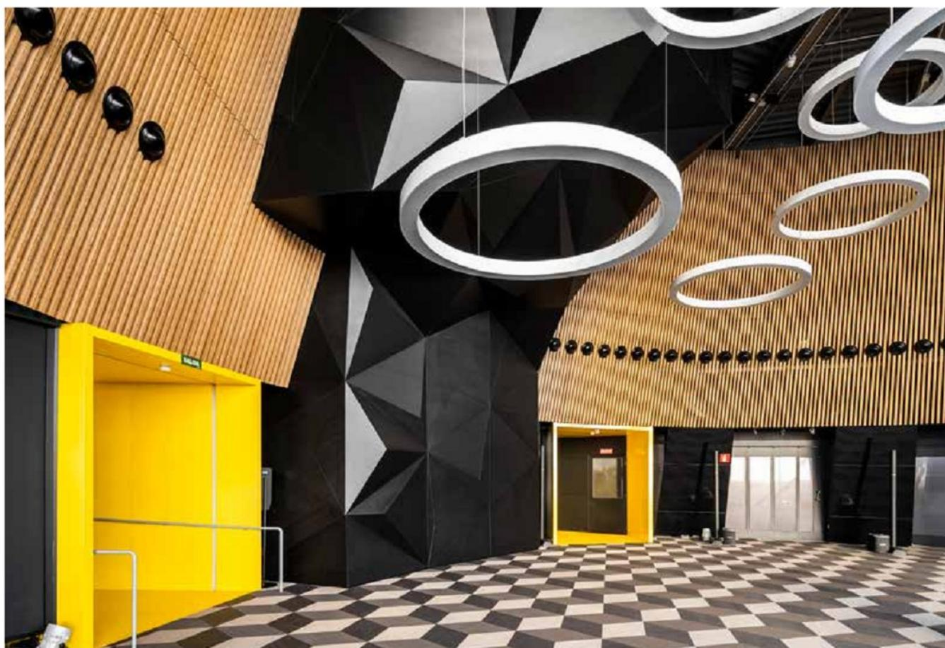
La sala de eventos del rascacielos luce un revestimiento tridimensional muy complejo a nivel técnico resuelto con bambú y tableros fenólicos contrachapados. El suelo técnico del espacio, que acaba de obtener la clasificación Leed Gold, se compone de láminas de acero y cemento aligerado que le confieren una elevada resistencia a las cargas.
